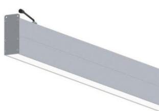
لیوسا برای نورپردازی داخلی به صوت آویز یا روکار استفاده می شود. دیفیوزر چراغ از جنس پلی استایرن و بدنه آن آلمینیوم اکسترود شده با رنگ پودری الکترواستاتیک می باشد. کلاس یک الکتریکی و درجه حفاظت IP54 می باشد. توان چراغ ۲۰ وات برمتر است. دمای رنگ : ۶۰۰۰ کلوین (نور سفید). کنترل دالی سفارشی می باشد. مک آدام : ۳ و شاخص نمود رنگ  $Ra > 80$  است.
