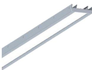
چراغ خطی توکار با روکار می باشد) است. ارتفاع کم چراغها امکان نصب را در سقفهای که محدودیت دارند (IP44) (سفارشی می پاشد) را فراهم می کند. توان چراغ ۲۵ وات بر متر می باشد. پوشش این چراغهاز دیفیوزرهای PMMA بوده که ساختار ویژه این دیفیوزرهای به گونه ای بوده که پس از روشن شدن چراغها نوری یکنواخت را ارائه می دهد. جنس بدنه چراغ آلومینیوم اکسترود شده با پوشش زنگ پودری است. دمای زنگ نور ۳۰۰۰ کلوین (نور زرد)، درجه ثبات زنگ نور (مک آدام): ۳ و طول عمر بیش از ۵۰۰۰۰ ساعت است.
