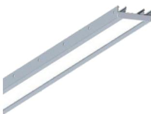
چراغ خطی توکار با روکار می باشد) این سفارشی است. ارتفاع کم چراغها امکان نصب را در سقفهای که محدودیت دارند (IP44) را فراهم می کند. توان چراغ ۱۵ وات بر متر می باشد. پوشش این چراغها از دیفیوزرهای PMMA بوده که ساختار ویژه این دیفیوزرهای به گونه ای بوده که پس از روشن شدن چراغها نوری یکنواخت را ارائه می دهد. جنس بدنه چراغ آلومینیوم اکسترود شده با پوشش زنگ پودری است. دمای زنگ نور ۳۰۰۰ کلوین (نور زرد)، درجه ثبات زنگ نور (مک آدام): ۳ و طول عمر بیش از ۵۰۰۰۰ ساعت است.
