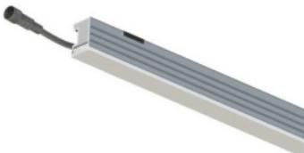
چراغ خطی توکار و روکار سام لاین قابل استفاده در محیط های داخلی و بیرونی (مشروط به داشتن درجه حفاظت IP65) می باشد دمای رنگ نور آن ۴۰۰۰ کلوین (نور طبیعی) است. پوشش چراغ از جنس PMMA و بدنه آن از جنس آلومینیوم اکسترود شده با رنگ پودری الکترو استاتیک می باشد. درجه حفاظت آن IP44 (IP54) به بالا سفارشی می باشد) به همراه ابیط های نزی و مادگی IP67 امی باشد. تون کلی چراغ ۱۲ وات بر متر، ضریب نمودرنگ CRI>۸۰ و گام مک آدام ۳ می باشد.
