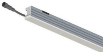
چراغ خطی توکار و روکار سام لاین قابل استفاده در محیط های داخلی و بیرونی (مشروطه داشتن درجه حفاظت IP65) می باشد دمای رنگ نور آن ۳۰۰۰ کلوین (نور زرد) است. پوشش چراغ از جنس PMMA و بدنه آن از جنس آلمینیوم اکسترود شده با رنگ پودری الکترو استاتیک می باشد. درجه حفاظت آن IP54 (IP44) به بالا سفارشی می باشد) به همراه رابط های نزدی و مادگی IP67 می باشد. تون کلی چراغ ۱۲ وات بر متر، ضریب نمودرنگ CRI>۸۰ و گام مک آدام ۳ می باشد.
